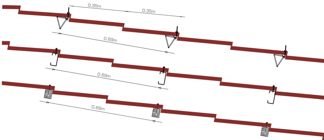
Las líneas de apoyo de la cubierta son perpendiculares al largo de la chapa y se recomienda una distancia entre las mismas no mayor a 0.69 m, coincidiendo con el escalonamiento de la chapa.
